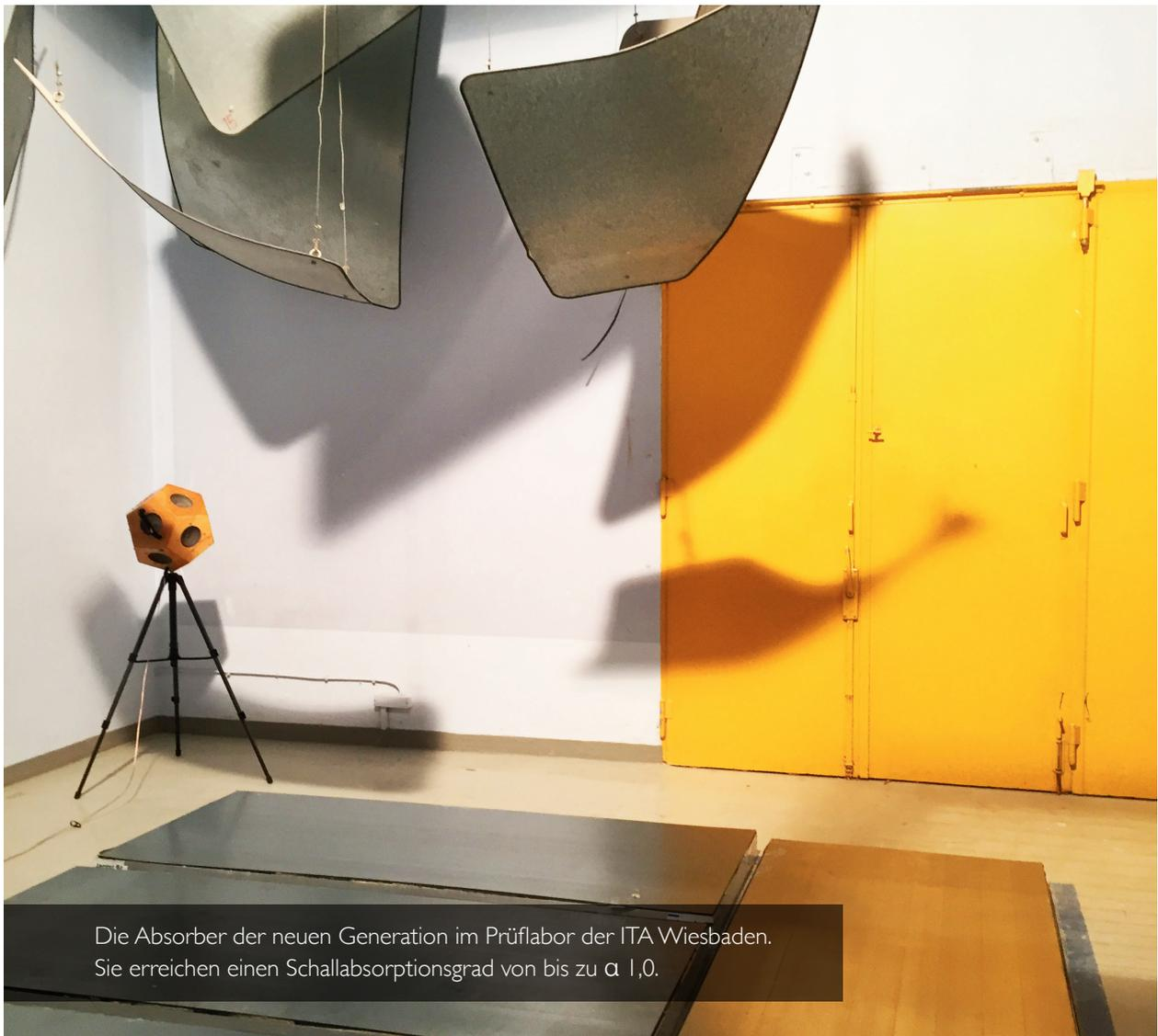
Die Absorber der neuen Generation im Prüflabor der ITA Wiesbaden.
